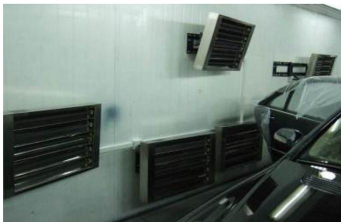
红外电磁波多频段加热装置
