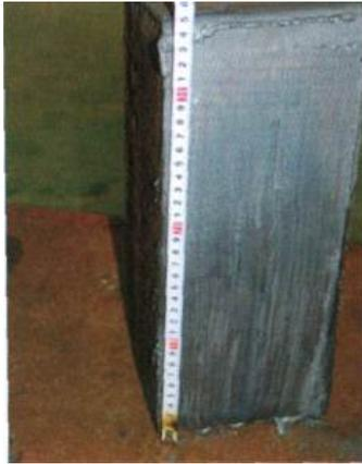
连铸坯切割断面图
