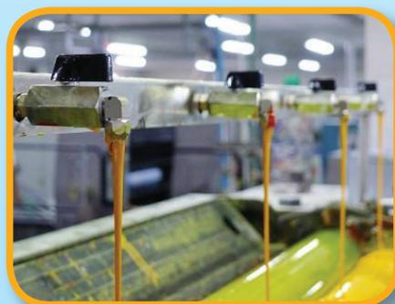
安裝在印刷機墨斗上的油墨添加管道
