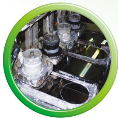
油盅式移印機的油墨密封於油盅內
