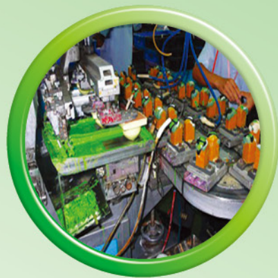
傳統油盤式移印機， 敞開的油盤散發VOC
