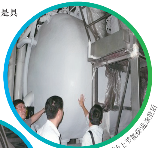
高温染色机表面没有任何保温措施
